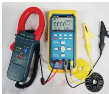
대전력 측정 (클램프 센서)
