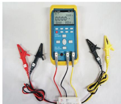
DC Load Wire 측정
